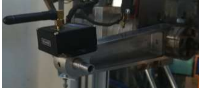
Şekil 12. Tahrik Sistemi Doğal Frekans Ölçümü
